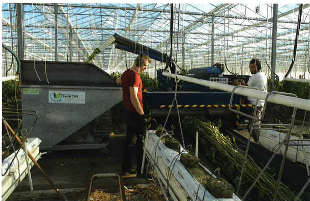
La nouvelle machine Bio Chopper Compact de TraitService broie les plants légumiers en fin de culture, avec un rendement de 2 ha/jour, en réduisant de 80 % le volume de déchets.
